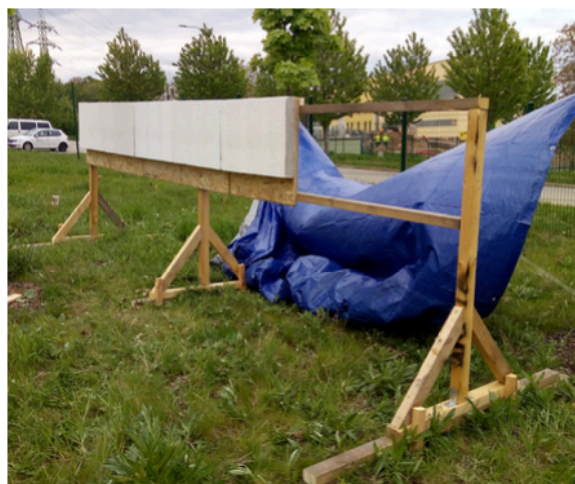
Montování vzorků na nosnou konstrukci
