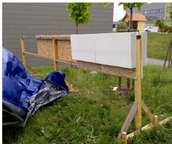
Montování vzorků na nosnou konstrukci
