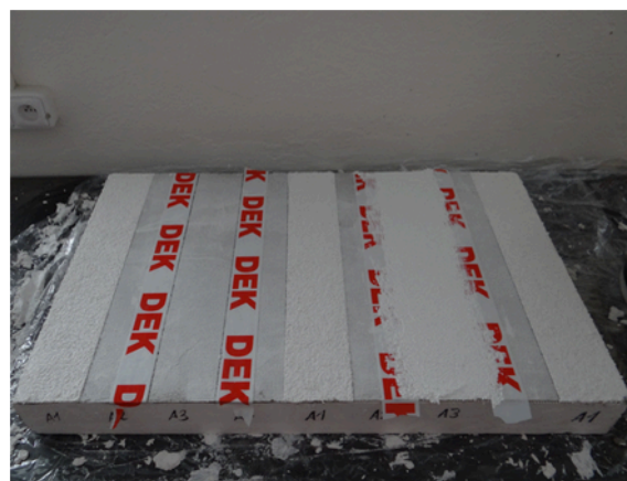
Nanášení jednotlivých povrchových úprav
